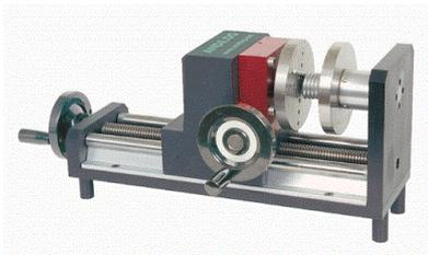
Dieser für die Kontrolle von Drehfedern konzipierte manuelle Drehmomentprüfstand ist die Lösung für die Durchführung Ihrer Drehmomentmessungen. Mit den neuesten Messtechnologien zeigt er auf einem einzigen Display die Drehmoment- und Winkelwerte.
